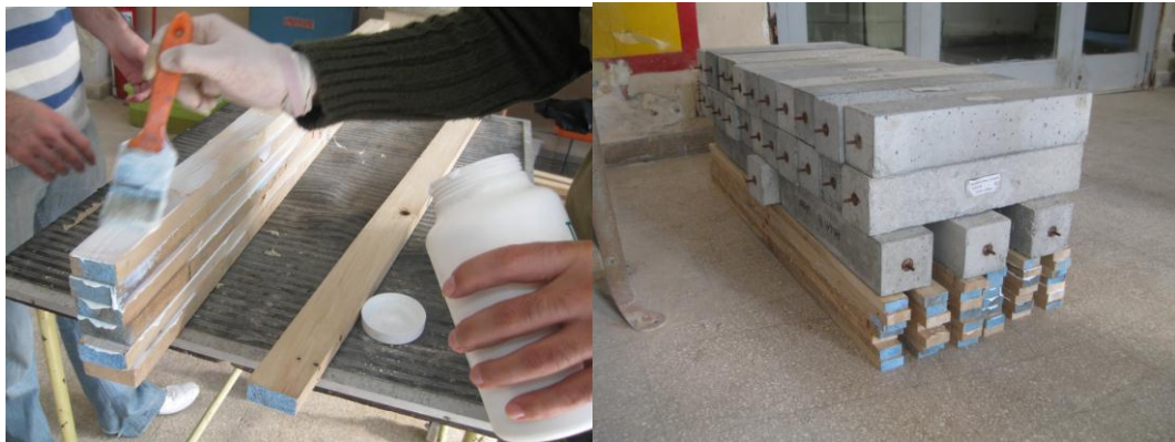
Figura 32 – Encolado y prensado de la madera
