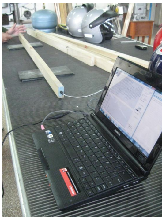
Figura 31 – Determinación del módulo de elasticidad (MOE)
