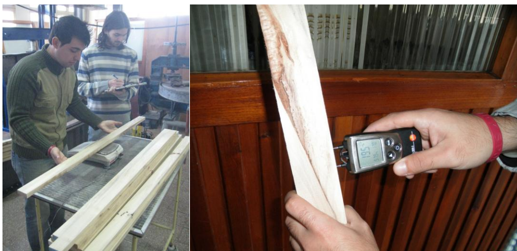
Figura 30 – Determinación de masa y la humedad de la madera
